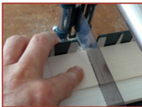
5. Alle Teile mit der Gehrungssäge ablängen (untergelegtes Holz vermeidet ein Ausreißen).
