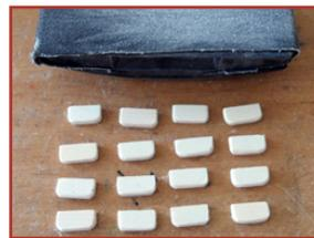
7. Ihre Kanten mit Schleifpapier leicht brechen. Die Schnittflächen der übrigen Teile plan schleifen.
