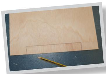
4. Den Deckel auf den Boden legen und die Ausdehnung der Nut übertragen. Auch hier beim Anzeichnen der Ausklinkungen beachten, dass die Nut maximal 30 mm betragen darf.
