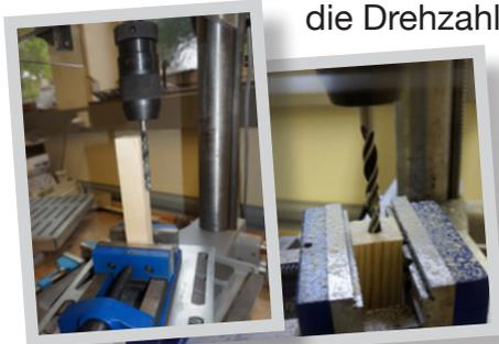
Ein exaktes rechtwinkliges Bohren ist möglich, wenn der Bohrer im Stillstand auf das Werkstück parallel ausgerichtet wird. Danach erst die maximale Bohrtiefe von 35 mm einstellen und begrenzen. Das Festspannen der Werkstücke ist zwingend erforderlich.
