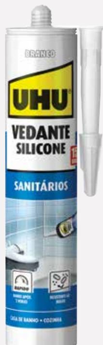
Vedante de silicone resistente à água de alta qualidade à base de ácido acético. Específico para vedações sanitárias. Indicado para selagem em banheiras, lavatórios, bancadas, divisórias, bidês, sanitas e entre parede de azulejos. Adere ao vidro transparente, cerâmica, azulejos, esmalte, metal, madeira e vários materiais sintéticos. Formulação fungicida.
