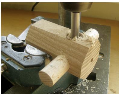
37. Den zweiten Riegel in den Verschlusskopf schieben und mit Ø 20 mm durchbohren.
