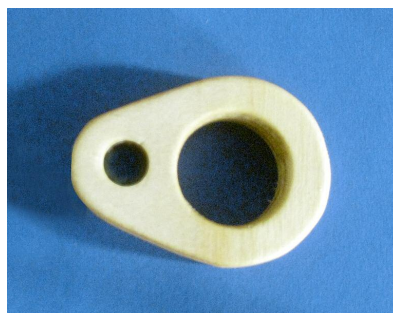
41. Mit Ø 20, Ø 10 und Ø 4 mm bohren und mit dem Tellerschleifer formschleifen.
