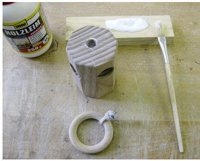
31. Sperrring mit befestigtem Tragering bündig in die obere Bohrung des Kopfes einleimen.
