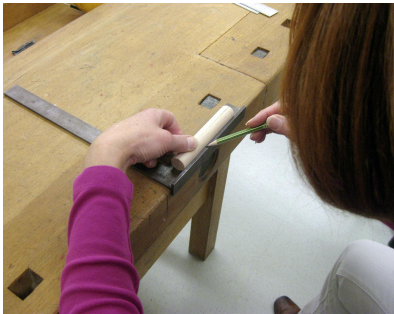
34. Die Seitenflanken mit dem Anschlagwinkel rechtwinklig anzeichnen, Bohrungen aufreißen und vorstechen.
