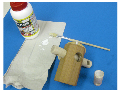
39. Die Riegelteile ausrichten und kreuzförmig in das Kopfteil einleimen.
