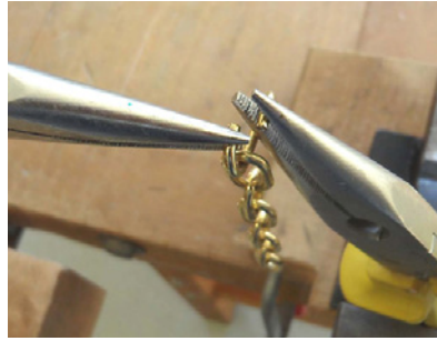
23. Ketten und Ring zusammenfügen: Ösen mit Spitzzangen aufdrehen und wieder schließen.
