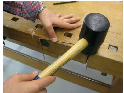
27. Biegungen mit dem Gummihammer nach- arbeiten.
