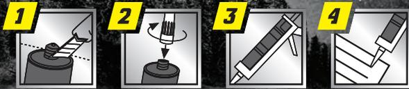
4. Appliquer la colle sur un côté, par points ou par filets, tous les 10 à 40 cm, sur une surface stable, propre et exempte de poussière et de graisse.
