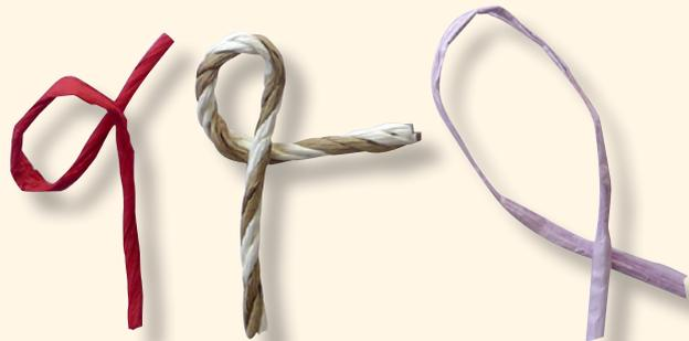
Die Stärke des Garns wird in der Maßeinheit **Nm** (Nummer metrisch) angegeben. Die Ziffer bezeichnet die Anzahl der Kilometer, die ein Kilogramm des Garns ergibt, wenn es ausgelegt wird. Je dicker das Papiergarn, desto kleiner der Wert, z. B.:
