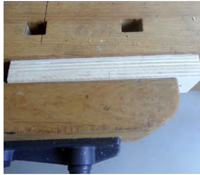
20. Bodenplatte und Mittelplatte bündig pressen und trocknen lassen.
