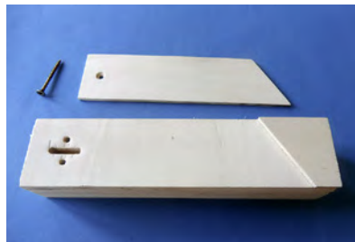
26. Den Dübel der Zwischenplatte B1 in die Bohrführung von B2 schieben. Anschließend die beiden Fallgewichte von oben einstecken.
