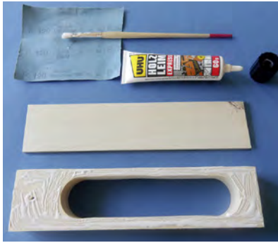
19. Die Bodenplatte auf die Unterseite der Mittelplatte leimen.
