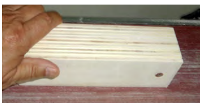
28. Unebenheiten rundum auf dem Bandschleifer beseitigen.
