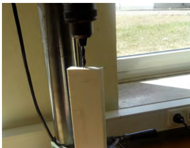
16. Die Sacklochbohrung an der Zwischenplatte B1 20 mm tief ausführen.
