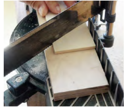
12. Die Deckplatte A1, A2 im 56°-Winkel mit der Gehrungssäge ablängen.
