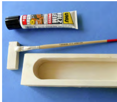
23. Zwischenplatte B2 bündig auf die Mittelplatte leimen ...
