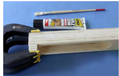
24. ... und mit der Federzwinde verspannen.
