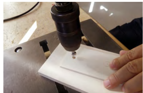
18. Mit dem Maschinensenker (Ø 10 mm) auf der Deckplatte A1 eine kegelförmige Vertiefung für die Spaxschraube herstellen.
