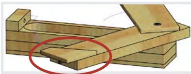
22. ... passend und bündig auf die Zwischenplatte B1 setzen, dabei B2 unterlegen. Mit der Federzwinde fixieren und trocknen lassen.
