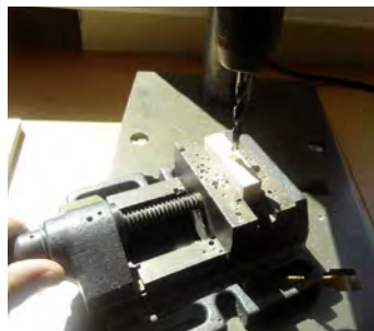
17. Die Sacklochbohrung an der Zwischenplatte B2 10 mm tief ausführen.
