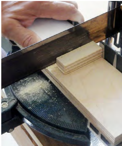
13. Die Zwischenplatte B1, B2 mit der Gehrungssäge ablängen.
