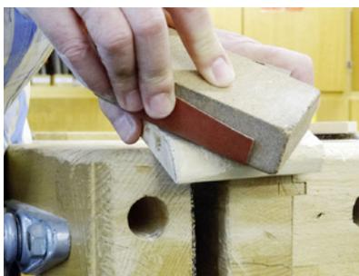
2. Die Kanten des Werkstücks mit der Feile entgraten, die Abrundung und alle Flächen mit einem feinen Schleifpapier glätten.
