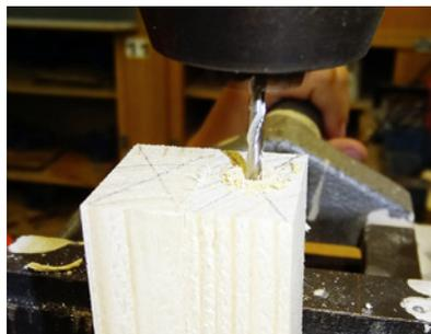
2. Löcher ( $\varnothing$  3,5 x 20 tief) in die Achsen bohren.
