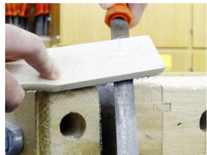
1. Die Abrundung am zugesägten Quader 4a anzeichnen (siehe Pfeil), raspeln und feilen. Die Werkzeuge nach der Bearbeitung mit der Feilenbürste säubern.
