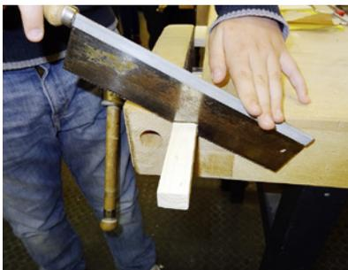
1. Die Quader 3a und 3b mit der Feinsäge im Schraubstock sägen.
