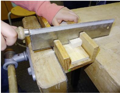
1. Die Quader 2c und 3c für die Fensterholme mit Feinsäge und Sägelade sägen.
