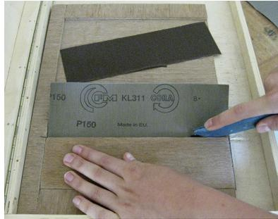
2. Handelsübliches Schleifpapier, 230 x 280 mm, mit Unimesser und Schneideschablone auf 230 x 70 mm zuschneiden (auf der Rückseite schneiden!).
