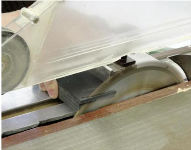
1. Materialzuschnitt von Holz und Kunststoff an Kreissäge durch den Lehrer.
