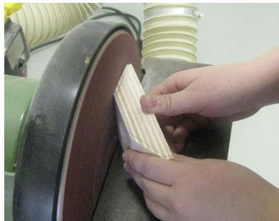
17. Die Schnittflächen mit dem Tellerschleifer plan schleifen.
