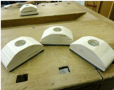
25. Die Schleifklötze zusammenbauen und verschrauben.
