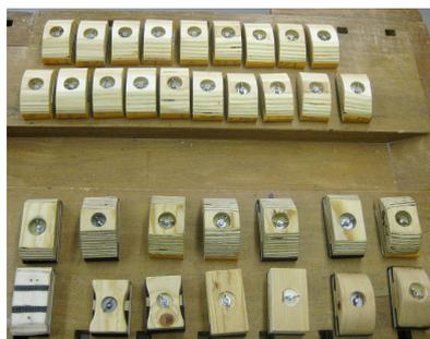
32. Schleifklötze aus der Serienherstellung und aus der vorausgehenden Einzelherstellung.
