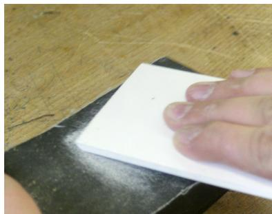
8. Mit Schleifkörper nachschleifen.
