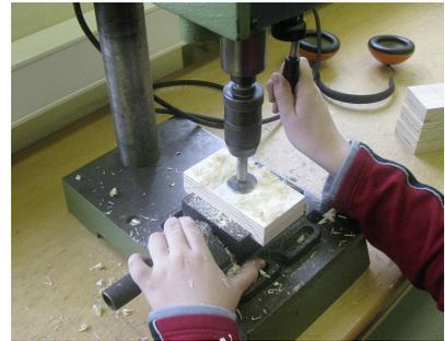
15. Die Bohrung im Maschinenschraubstock ausführen.
