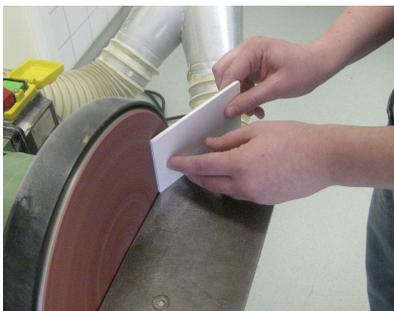
7. Mit dem Tellerschleifer beide Schleifpapierauflagekanten an der Schleifplatte in R3 abrunden.
