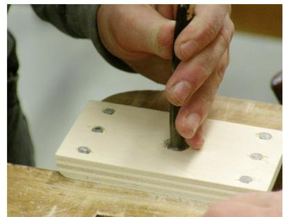
18. Mit Hammer und Durchschlag Nägel und Schraube in die Unterseite einbauen.
