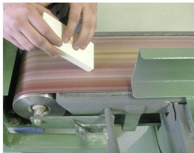
5. Beide Schleifpapierauflagekanten der Grundplatte am Bandschleifer mit R3 abrunden.
