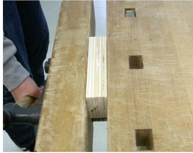
11. Bündig im Schraubstock pressen und etwa 15 Minuten trocknen lassen.
