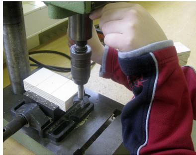
14. Eine Bohrtiefe von 20 mm für die Sacklochbohrung von 35 mm Ø einstellen.
