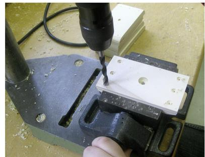
6. Sieben Durchgangsbohrungen und sieben Sacklochbohrungen an der Grundplatte durchführen.
