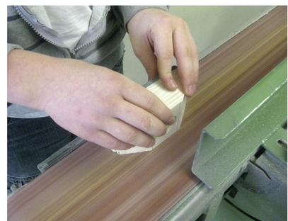
21. Kleine Ungleichmäßigkeiten an den Seitenflanken mit dem Bandschleifer korrigieren ...
