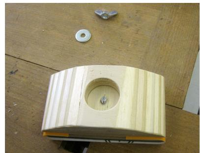
30. Das Oberteil bündig aufsetzen, mit Unterslegscheibe und Flügelmutter verschrauben.
