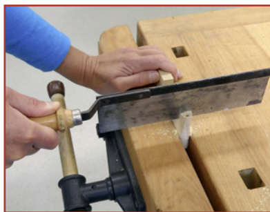
11. Gerundete Stufen und Nuten aussägen ...
