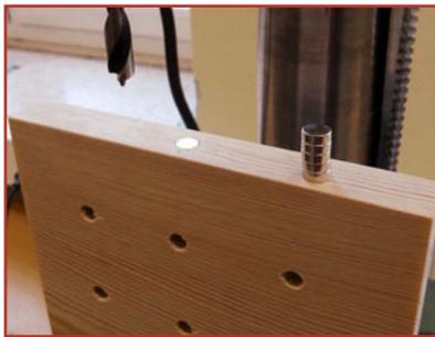
13. Für die Magnete an zwei gegenüberliegenden Seiten 3 mm tiefe Sacklochbohrungen von 8 mm Ø ausführen.
