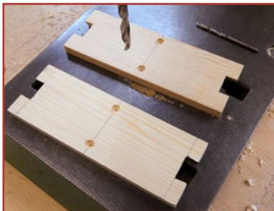
16. Für die Gegenstücke der Magnete (= Zylinderkopfschrauben), 2,5 mm tiefe Sacklochbohrungen von 7 mm Ø ausführen.
