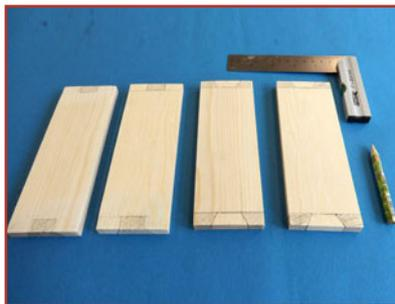
1. Die Schwalbenschwanz-Eckverbindungen aufreißen.
