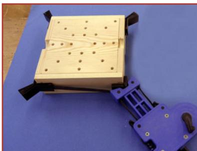
22. Mit einer verstellbaren Geh-rungs-pressen fixieren und den Holzleim trocknen lassen.
