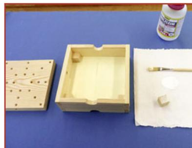
21. Bodenplatte einlegen, mit einer geeigneten Trennschicht abdecken und die Abstandswürfel in die Ecken einleimen.
