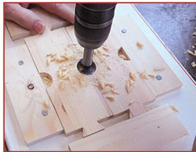
15. Für die Griffmulden am Gehäuse Halbierungsbohrungen von 25 mm Ø durchführen, Bohrschablone verwenden.
