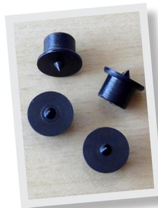
Dübelhilfen passen perfekt in das vorgebohrte Loch und können problemlos wieder entnommen werden. In die geprägte Markierung am Gegenstück wird die Zentrierspitze des Holzbohrers eingesetzt.
