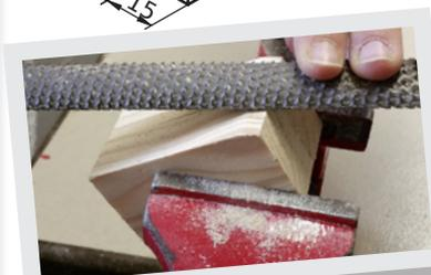
Eine leicht schräge Fläche für die Motorhaube feilen.
