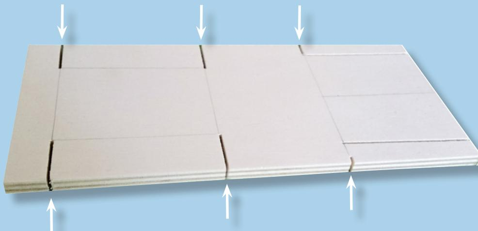
Falls die Schüler das erste Mal mit der Laubsäge arbeiten, könnte die Lehrkraft einige Schnitte an der Bandsäge ansägen.
